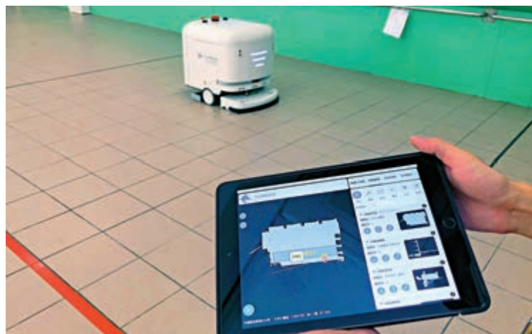
◀清潔機械人可以按照預設的路線和速度打掃場地，快捷又方便
