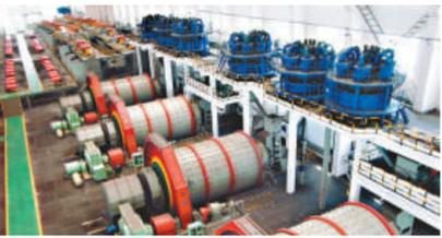
▲國內有色冶金最大的選礦磨浮生產線——每日14000噸選礦磨浮生產線 柯玉棟攝
