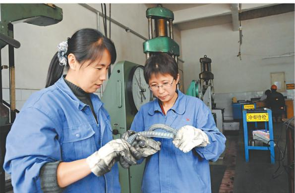
▲西鋼質檢處對鋼材進行物理性能測試——冷斷測試，圖中鋼筋彎到 90 度都沒有斷裂的跡象
