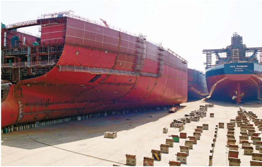
▲熔盛的「全球第一塢」容量超大,可以同時容納兩艘在建的40萬噸VLOC礦砂船 本報攝
