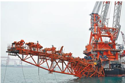
▲「海洋石油201」鋪管船,船尾伸出海面是鋪管導架,工人正在作最後的調試,背後是四千噸起重機的吊臂
