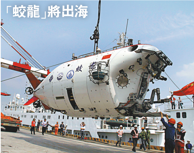
5月31日，「蛟龍號」載人深潛器在江蘇江陰的蘇南國際集裝箱碼頭順利安裝至試驗母船「向陽紅09」。「向陽紅09」船將於6月3日載「蛟龍號」赴馬利亞納海溝向載人深潛7000米級海試發起衝擊 新華社
