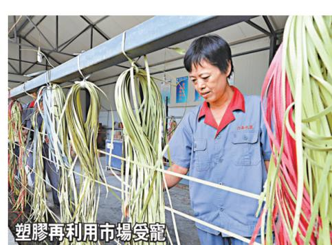
膠州再生資源生產廠，用自主研發的生產機械，把回收來的廢舊塑膠經粉碎、清洗、挑揀、瀝乾、加溫、拉伸、打捲等流程，生產出六十餘種打包帶，廣受紙張、板材、陶瓷等產品生產廠家歡迎。圖為工人在包裝帶生產線上瀝乾產品的水分。 新華社
