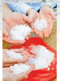
簡稱PP的聚丙烯（Polypropylene）為丙烯的聚合物，是一種半結晶的熱塑性塑料，具有「加熱軟化、冷卻硬化」的特性。聚丙烯容易加工成型，加上生產成本較低，用途非常廣泛。不過缺點是容易老化及變形，變得
