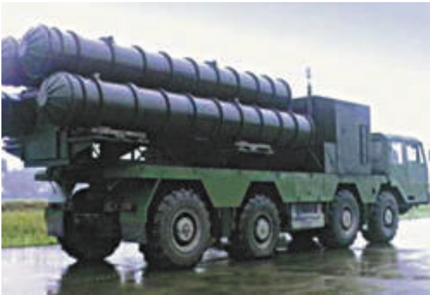
▲FD-2000是中國自主研製的中遠程防空導彈武器系統，可同時制導16枚導彈攔截8個目標
