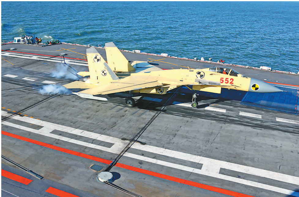
▲殲-15着艦時尾鉤與飛行甲板上的阻攔索裝置咬合
