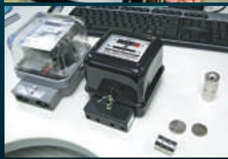
▲ 用以測試電錶：左為日本製，右為內地出品，強力磁石則於右上方
