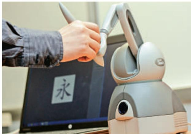
▲觸感仿真平台有力量反饋功能，可將用的手推到正確方向，有助兒童學寫字
