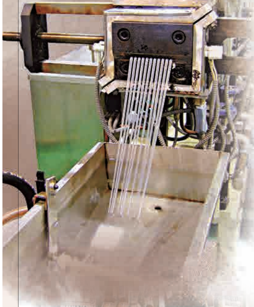
▼傳統的塑料造粒機，透過機器的冷凍及打碎等程序，將其變成粒狀 生產力促進局圖
