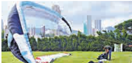
▲越野速度賽使用的滑翔傘，翼肋窄而密的滑翔傘，翼肋較寬疏
