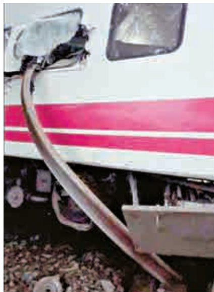
▲鐵軌彎曲嚴重甚至插入車廂內 網上圖片
