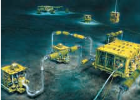
▲陵水氣田水下生產系統示意圖 網絡圖片
