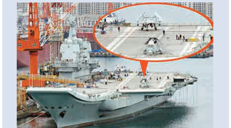
距首艘國產航母完成第三次海試返港已過一個月。5日傍晚，兩架全尺寸艦載機模型再次亮相航母，甲板同時掛出四道阻攔索，並有一輛黃色甲板牽引車出現（紅圈示），顯示其正進行甲板調度試驗。艦島部位出現焊接火光，船廠工人正加緊施工。（記者 宋偉）
