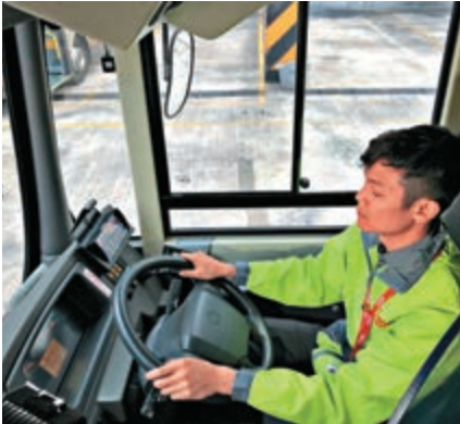
▲九巴試驗車長睡意監察系統，前方感應器偵測車長眼部動作，當車長閉目時會發出提示聲，部分供應商系統更有震動座椅功能 大公報記者陳卓康攝
