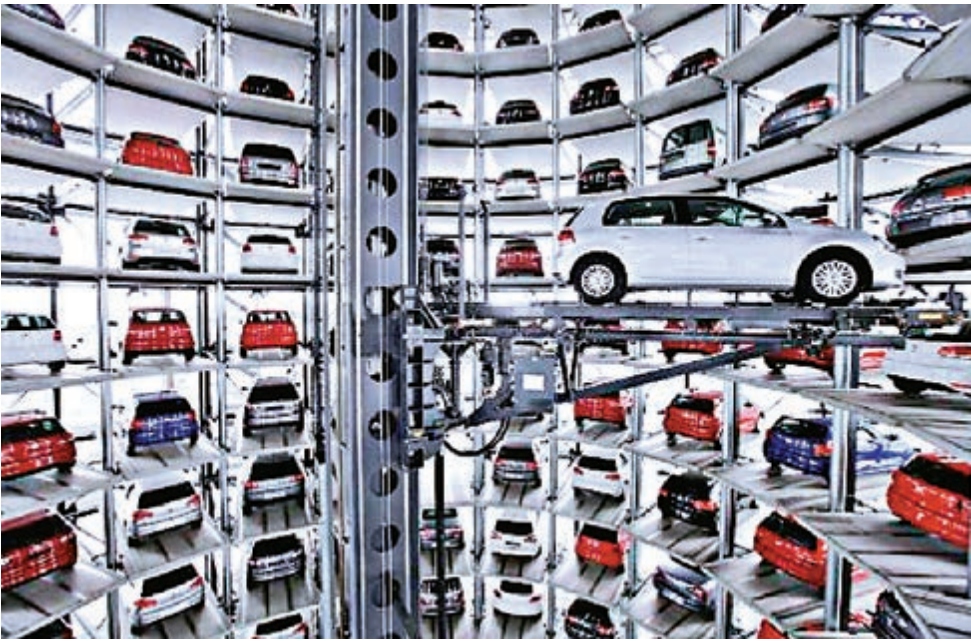
▲深水埗的地下智能停車場將採用圓軸垂直式升降操作方法，存取車輛速度較快
