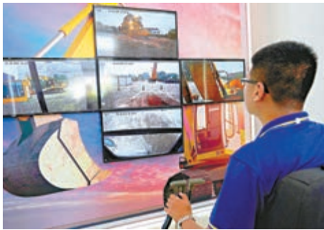
▲18日，工作人員使用5G網絡遠程操控挖掘機作業
