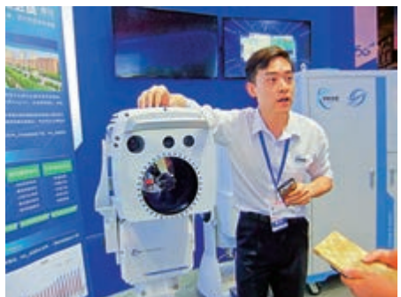
▲博覽會上展示的便攜式顆粒物激光雷達，可精準判斷污染源，實現精細化管控污染治理 大公報記者陳旻攝
