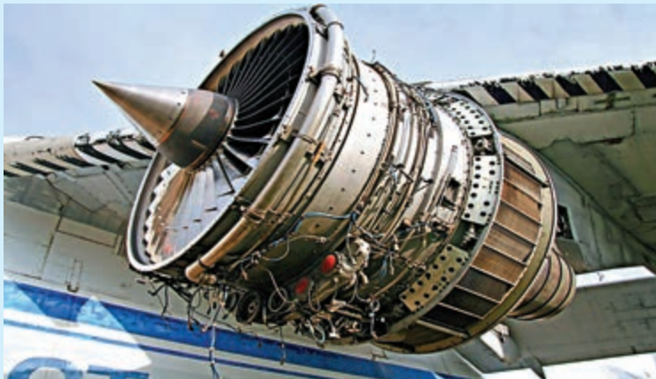
▲西奇生產的D-18T發動機，用於大型運輸機AN-124 網絡圖片
