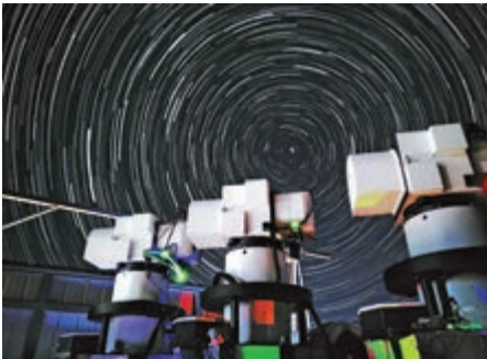
▲延時攝影下的阿里地面站望遠鏡，用於與「墨子號」進行量子通信 資料圖片
