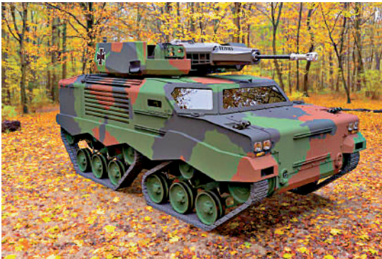
▲德國LuWa空降戰車採用四履帶底盤的結構，為戰車的機動能力提供了重要支撐。
