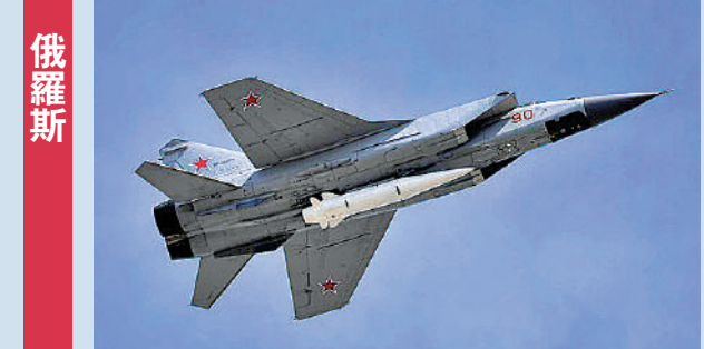
匕首 ：空射高超音速飛彈據稱射程超過2000公里，速度能達到10馬赫，可從米格-31戰鬥機上發射。
