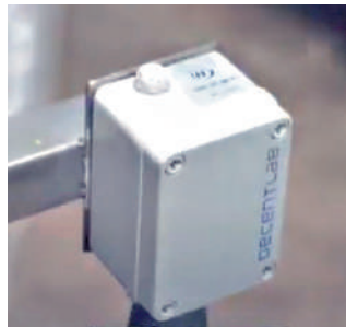
◀渠務署透過水位傳感器實時收集河流和水道的水位、雨量及潮汐等數據。
