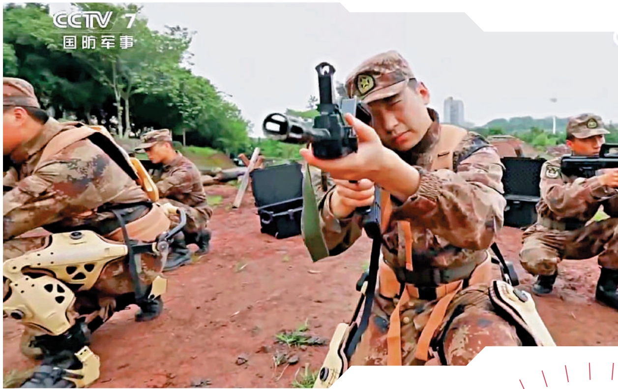
▲衛生員單兵外骨骼可將重量傳導到地面（如右圖白色箭嘴示），為佩戴的士兵減負。
