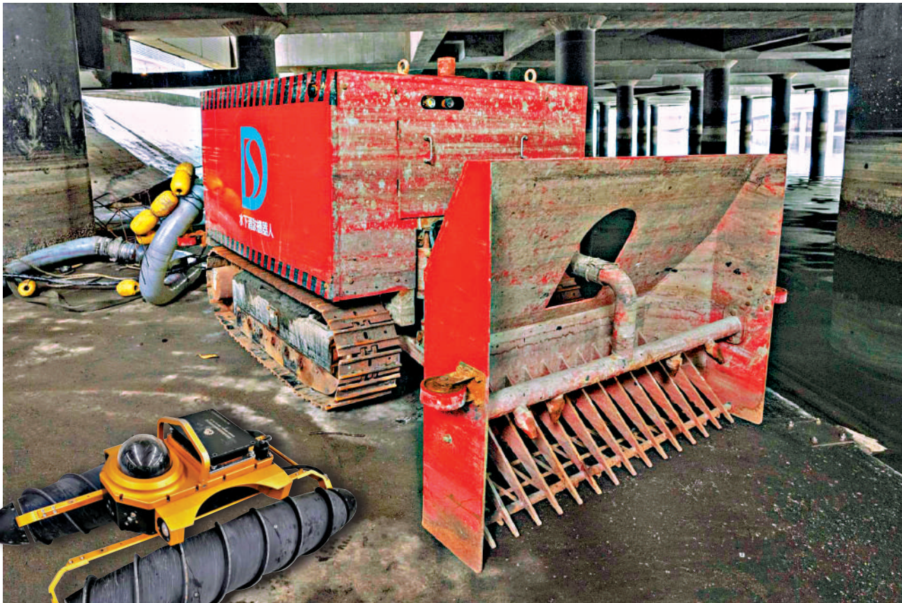
◀▲渠務署引進新科技，包括河道清淤機械人「深水清」（上圖）和管網檢測機械人「聲探」（左下圖），協助維修保養和清理淤泥。
