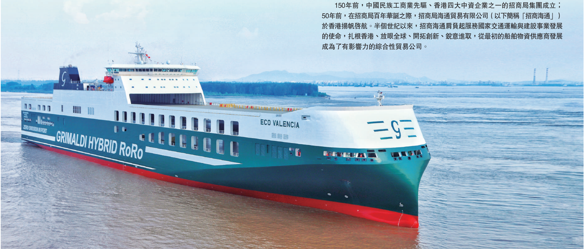
▲意大利Grimaldi集團7800車道米滾裝船採用了香港海通代理的5兆瓦大容量蓄電池混合動力系統，在全球綠色航運的發展史上具有里程碑的意義。
