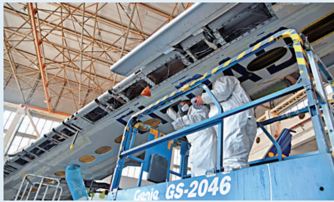
▲工程師檢修飛機機翼油箱。資料圖片
