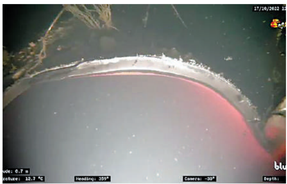
▲2022年10月，「北溪」管道受損畫面曝光，可見部分管道已經斷裂。視頻截圖
