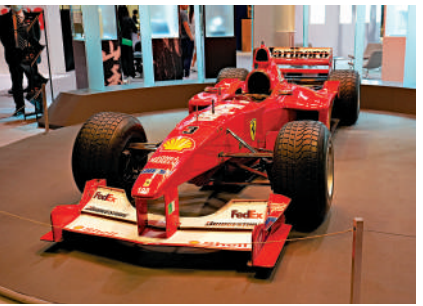
助舒馬赫贏得世界冠軍的傳奇戰車 法拉利F1-2000 ，可輸出700匹馬力，採用V10引擎，搭載縱向半自動順序七速發動機。底盤編號為198，於退役後經廠商全面修復，獲得法拉利認證，可參與法拉利的F1客戶活動。
