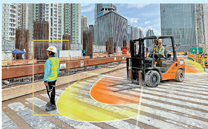
▲重型機械操作區域偵測警報系統若偵測到有工友的RFID標籤頭盔接近警戒範圍，剎車便會主動發出警報警響。
