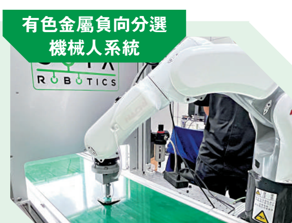
▲有色金屬負向分選機械人系統正在演示分揀過程，回收工廠使用該系統每天可處理大約20噸固體廢物。
