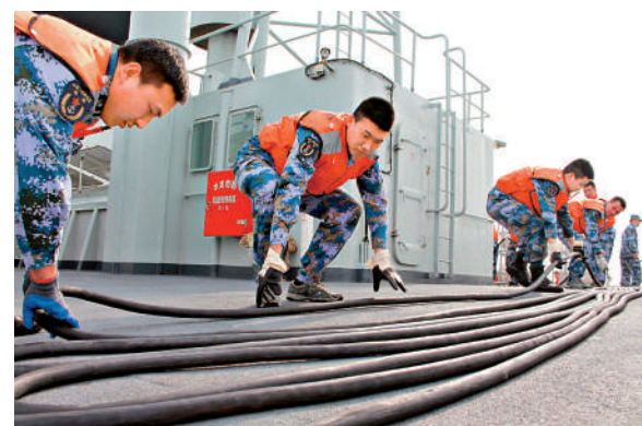
◀海軍消磁兵鋪放電纜，準備進行消磁作業。
