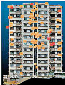
◀人工智能技術分析外牆破損位置，分類及評估嚴重程度。
