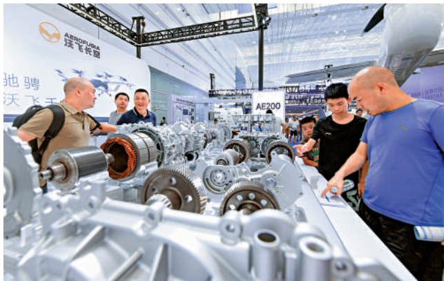
▲9月1日，在動力電池產業鏈供應鏈成果展示活動上，參觀者在了解新能源汽車800V雙電機驅動系統。
