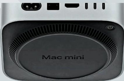
▲Mac mini4的電源鍵被放置在設備的底面。
