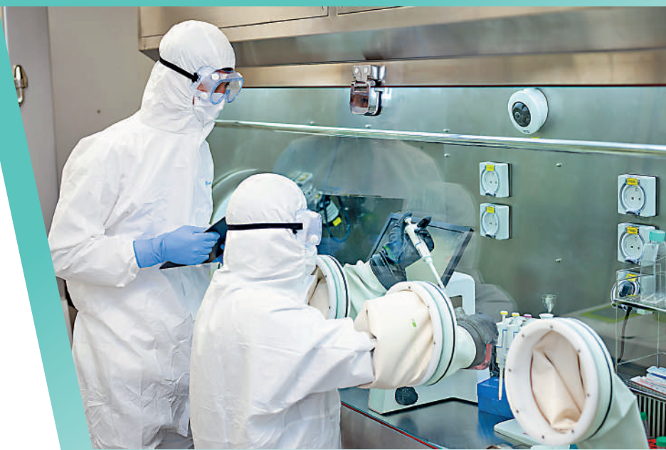
▲實驗室的生產區有A級製藥用隔離裝置，確保生產過程在無塵室標準的環境下完成。
