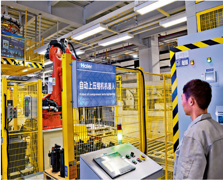
▲在山東的海爾AI賦能多聯機互聯工廠內，工人查看自動上壓縮機機器人作業情況。 新華社
