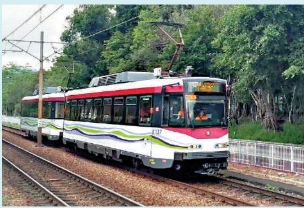
▲兩架安裝了「樹木監察系統」的輕鐵，車頂的光學雷達會在行駛中自動收集沿線樹木高度、外形及與輕鐵行駛範圍的距離等數據。
