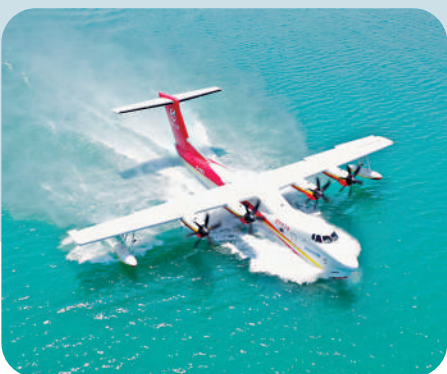
▲AG600最大起飛重量60噸，可在20秒內實現12噸快速水面汲水。
