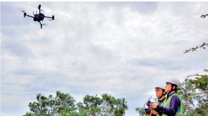
▲中電在西貢西灣測試超視距飛行，包括遙控無人機及用自動飛行模式巡查架空電纜。
