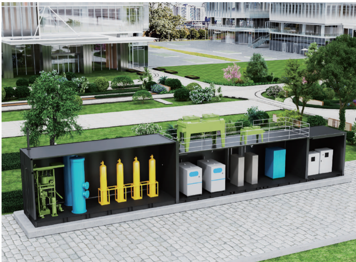
▲充電系統模型模擬系統的設備，包括抽氫、發電、儲能，以及電力控制的設備。項目落成後將會從現有的燃氣管網中提取氫氣，以供應氫氣予氫燃料電池進行產電，為園區內的電動車充電樁供電。
