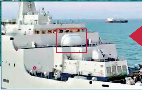
▲央視軍事日前披露的畫面中，四明山艦76毫米艦炮後方平台上已加裝一個半球形外罩，即燎原-1。
