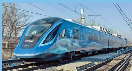
◀首列國產氫動力火車的續航里程超過1000公里，減低中途加油的需要。
